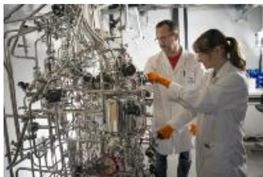
Pilote pour la valorisation et l'utilisation du gaz CO<sub>2</sub>. Ce gaz est transformé par des micro-organismes pour en faire des molécules d'intérêt : des alcools (énergie), des lipides, des protéines... Ce pilote s'inscrit dans la thématique du carbone renouvelable ou de la diminution de gaz à effet de serre. © **Jean-Claude Moschetti / TBI / CNRS Photothèque**
