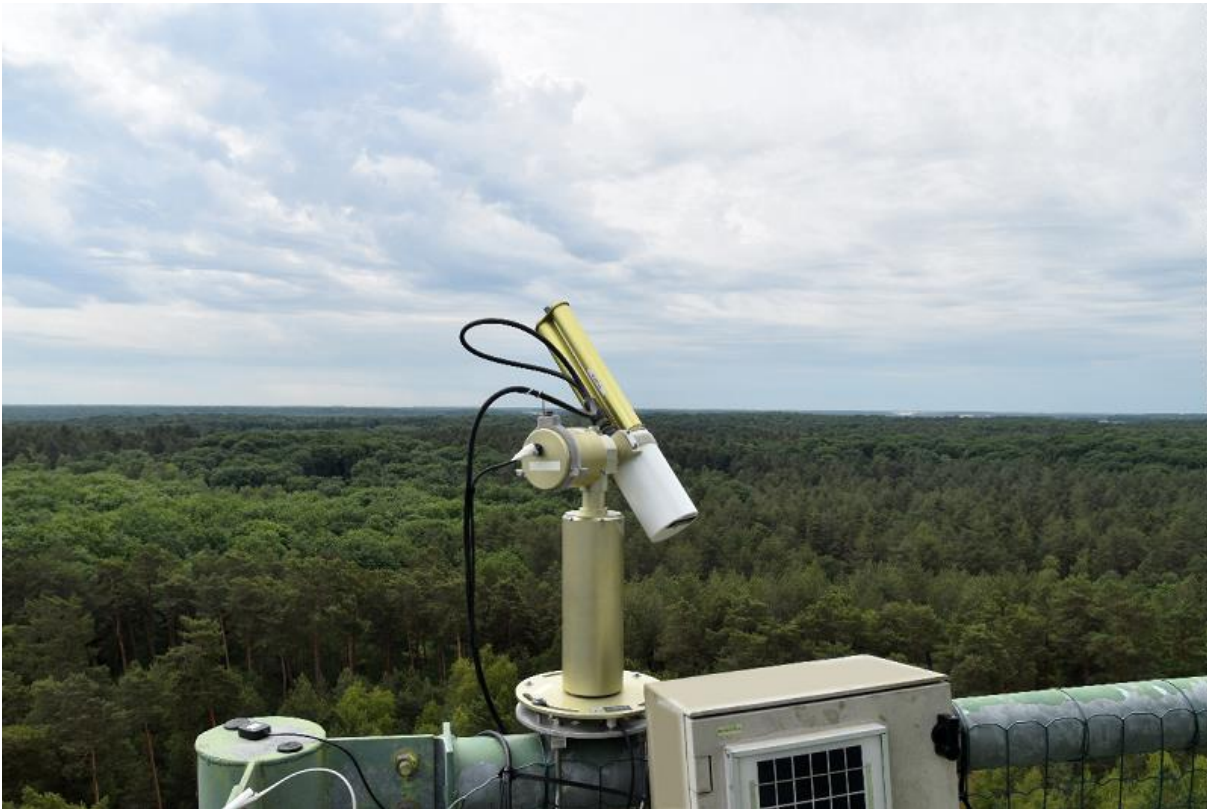
Photomètre scrutant la quantité d'aérosol au-dessus de la Forêt de Rambouillet depuis la tour d'observation ACROSS
